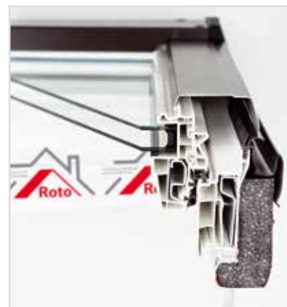
MEDIUM+ kivitel esetén gyárilag előszerelt Hőszigetelő Csomaggal (WD) és belső párazáró csatlakozással
